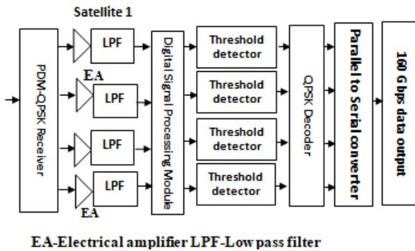
Figure 1. (d) Internal structure of PDM-256-QAM Receiver
